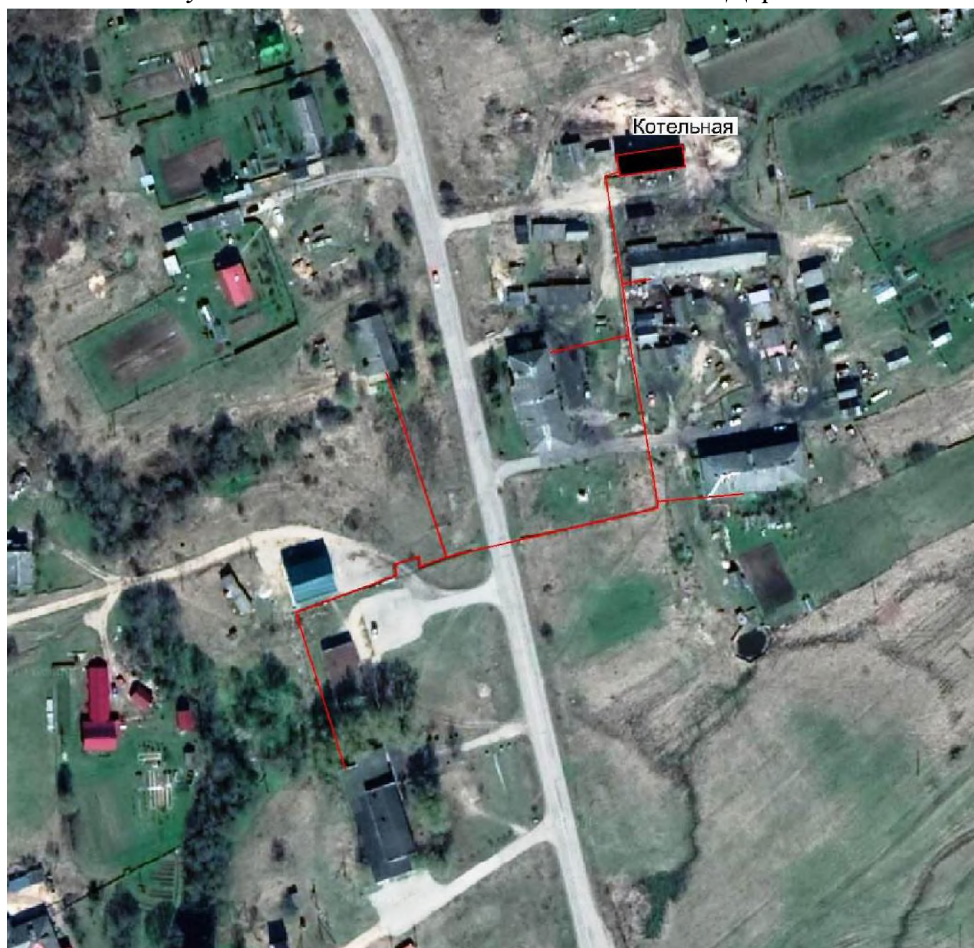
Рисунок 2.6 – Зона действия котельной д. Порожки
